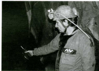
Photographie 4 : Mesure de CO 2 atmosphérique dans une cavité. Cliché J.-M. Ostermann.
